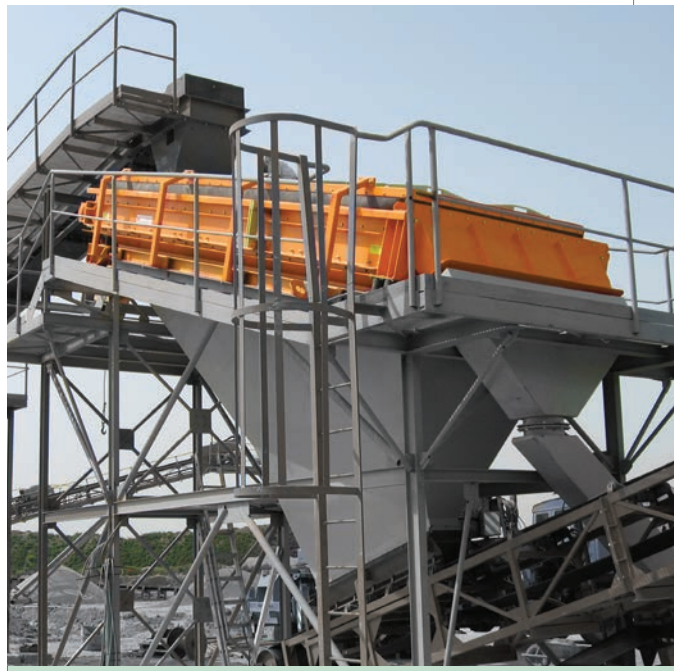
Грохот с натяжным валом TRISOMAT для трудно просеиваемых материалов Flip-flip screen TRISOMAT for difficult-to-handle materials
