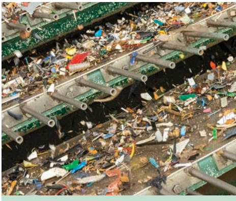
Камнеотделитель для сепарации твердых и легких материалов Destoner for the separation of heavy, solid particles from light, flat particles
