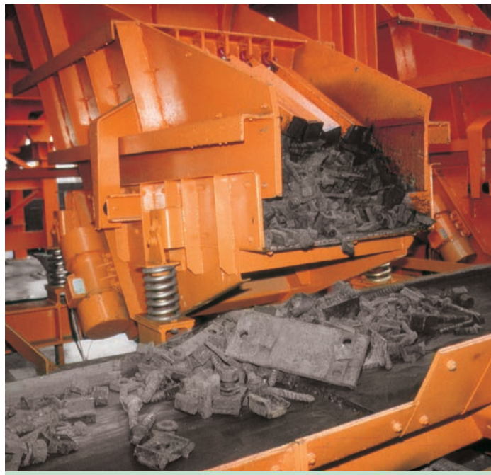
Выгрузка лома с помощью дебалансного транспортного лотка Hopper discharge of scrap with unbalanced motor feeder
