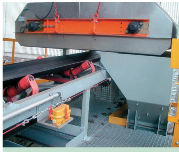
Отделение примесей железа с помощью надконвейерного сепаратора Tramp iron separation with magnetic overband separator
