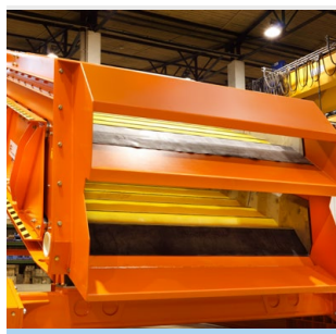
TRISOMAT в двухдечном исполнении TRISOMAT in double-deck design
